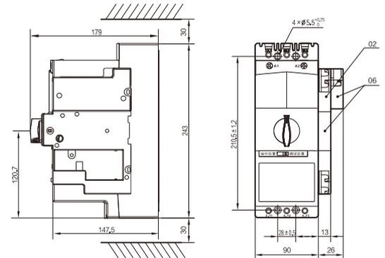
●安装方式：M5 × 20螺钉安装
