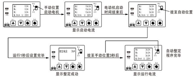
注1：上述运行10秒指出厂已设置好的启动时间，但该时间为0-60秒可调，如出现在10秒启动时间内电机还未启动完成，则可在设定参数中启动时间调整。
