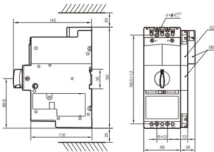
●安装方式：M4 × 45螺钉或TH35导轨安装
